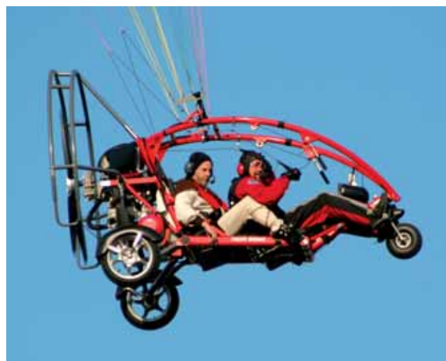
XCitor-Pilot Hermann Pieper (vorne) und sein Passagier genießen in dem unter einem Gleitschirm angebrachten Fahrgestell frische Höhenluft. Dieses Gleitschirmtrike ist in Österreich das kleinste und leichteste als UL zugelassene Fluggerät.
