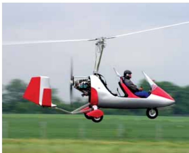
Gyrocopter: Der Tragschrauber erfreut sich wachsender Beliebtheit. Sein Antrieb befindet sich hinter dem hinteren Sitz. Der Rotor wird nur durch den Fahrtwind in Drehung versetzt.
